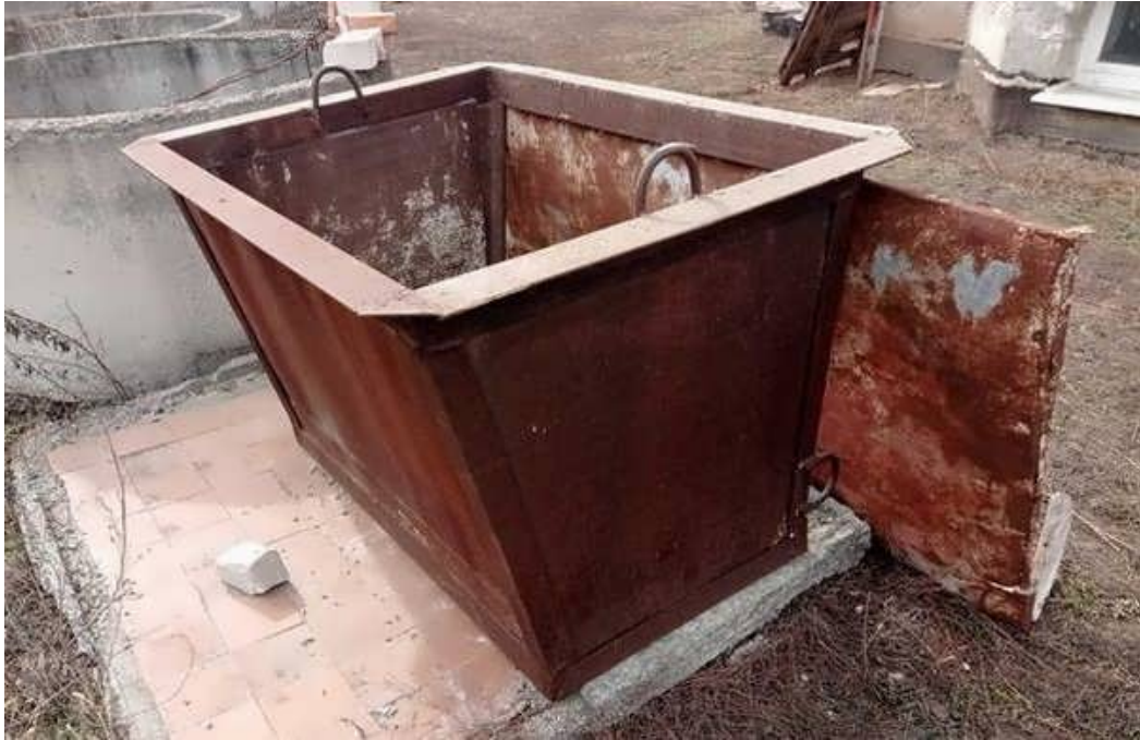
На производственной таре не указан ее номер, назначение, собственная масса, максимальная масса груза, для транспортировки и перемещения которого она предназначена
