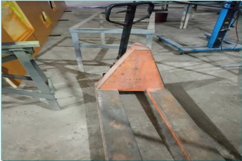
На грузовой тележке не указаны грузоподъемность, инвентарный номер, наименование структурного подразделения организации
