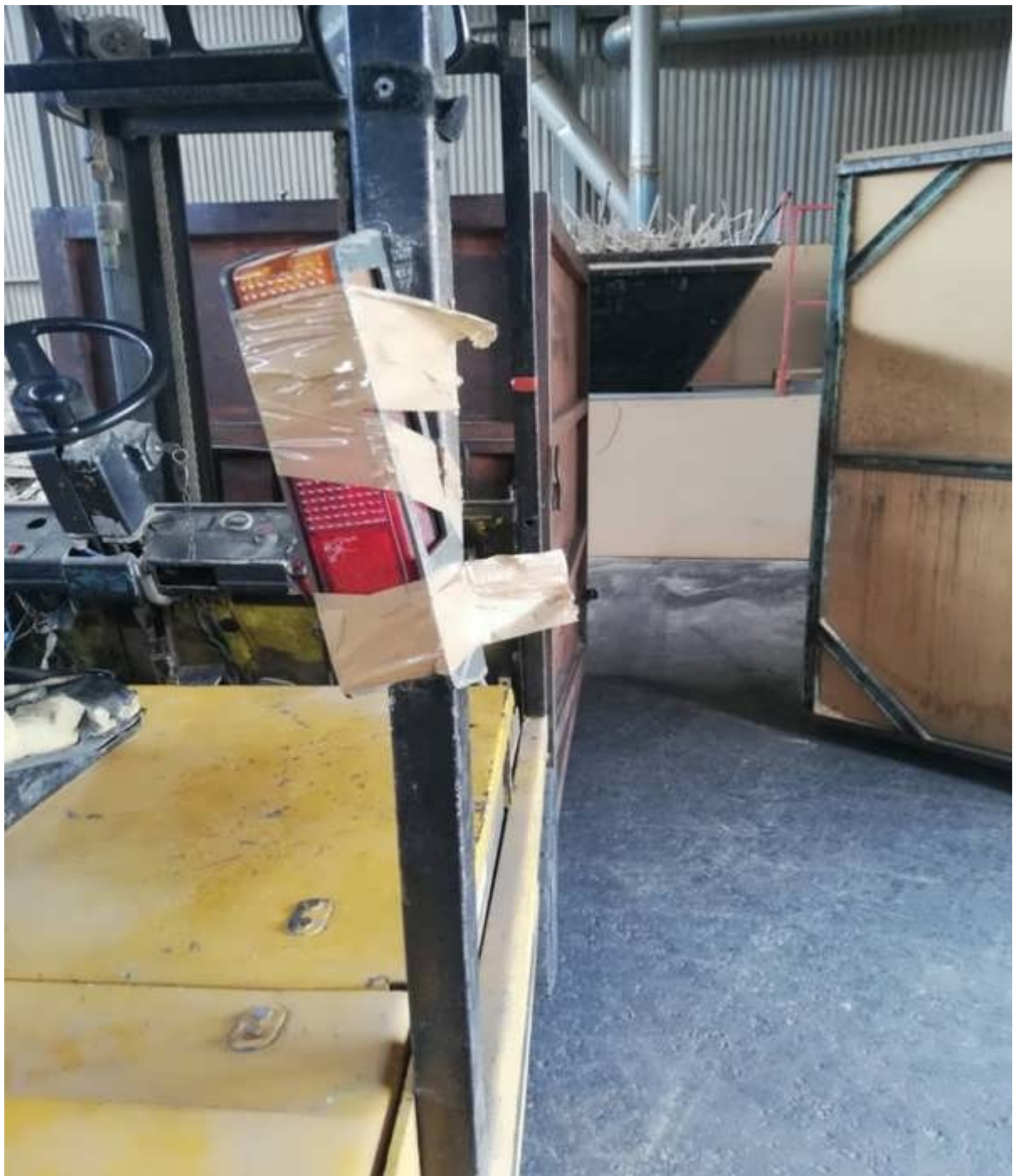
На погрузчике повреждена светосигнальная аппаратура, оставлен ключ в замке зажигания
